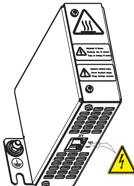
Abbildung 8: Gefahrenbereiche bei der elektrischen Installation
