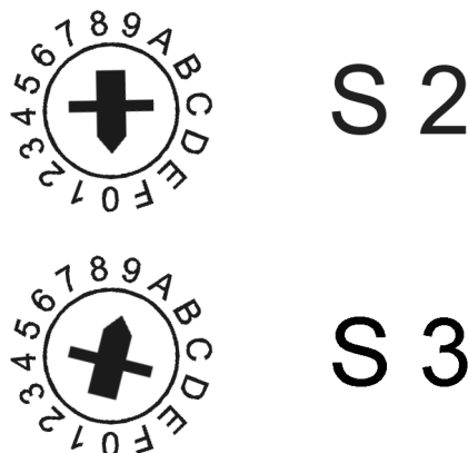
Abbildung 15: Beispiel: Einstellen der Ethernet-Adresse 192.168.1.10 (Drehschalter S2 auf 0, Drehschalter S3 auf 9)
