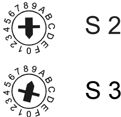
Abbildung 20: Beispiel: Einstellen der Ethernet-Adresse 192.168.1.10 (Drehschalter S2 auf 0, Drehschalter S3 auf 9)
