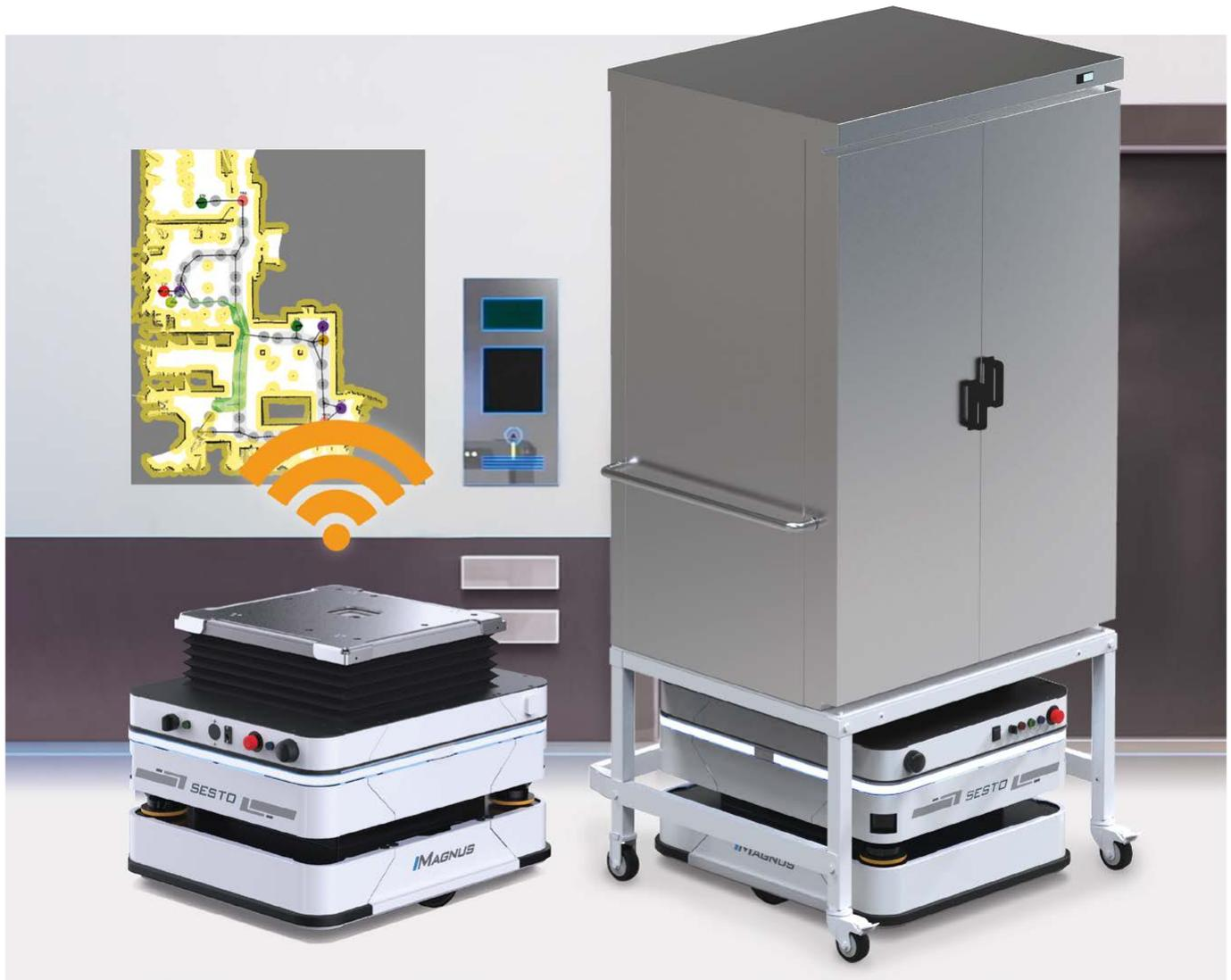
Für die freie Navigation im Raum erfasst der AMR in einer Lernfahrt die räumliche Situation mittels LIDAR-Sensoren und speichert diese Information als Landkarte für die Fahrzeugflotte ab. Die Modifizierung der Landkarte erfolgt mit einem in der webbasierten Oberfläche integrierten Editor. Hierbei werden dann Positionen und das „Straßennetz“ mit verschiedenen Funktionen platziert.
