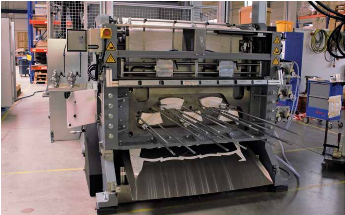
▲ Yeni zımbalama makinesi Drusula 1200, 1.250 mm'ye varan bir bant genişliğine sahiptir
